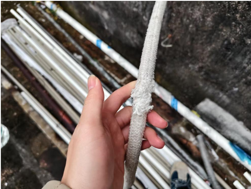
图 9 现场高空作业绳索磨损情况
