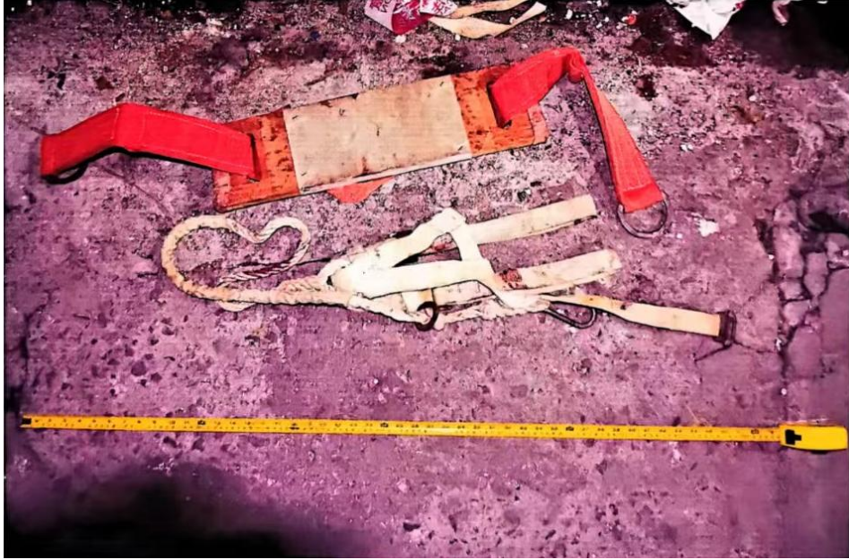
图 4 现场一楼地面上发现的坐板及安全带状况
